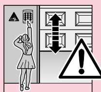
**Festinstallierte Steuerungsgeräte (wie Taster etc.), sind in der Sichtweite des Tores zu montieren, aber entfernt von sich bewegenden Teilen und in einer Höhe von mindestens 1,5 m. Sie sind unbedingt außer Reichweite von Kindern anzubringen!**
