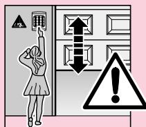
**Les appareils de commande fixes (par exemple boutons-poussoirs) doivent être placés en vue de la porte, mais à distance des pièces mobiles et à une hauteur minimale de 1,5 m. Ils doivent absolument être installés hors de portée des enfants!**
